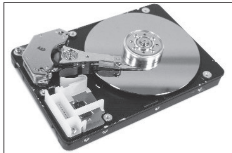
Figura 45 L'interno di un hard disk
